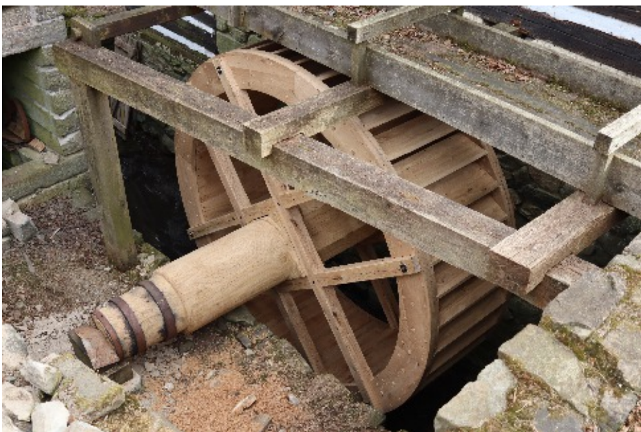
Nová hřídel a vodní kolo na vrchní vodu vodního obilního mlýna na Veselém Kopci
