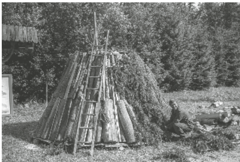
Experiment je nedílnou součástí práce v muzeích v přírodě, jelikož některé zaniklé nebo málo používané technologie nelze jinak obnovit. Jedním z příkladů je experimentální pálení mlíře ve Valašském muzeu v přírodě. Foto: Jaroslav Jurka, 2002. Z fotoarchivu Národního muzea v přírodě
